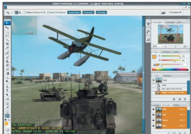
Биплан — это 3D-модель. Остальное — растровая картинка (скриншот из Assault on Atlix). Обратите внимание, что моделька выделена (гиперселекционирована). Дело в том, что на большинстве машин CS3 работает с трехмерной графикой в программном режиме.
